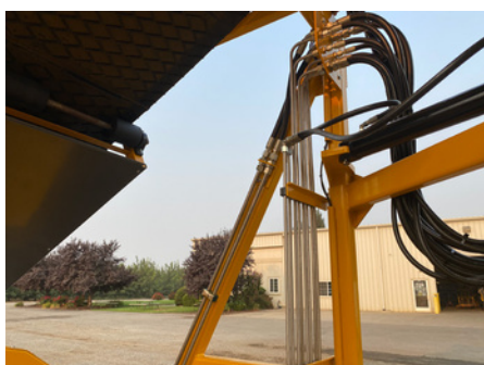
Гидравлические линии из нержавеющей стали
